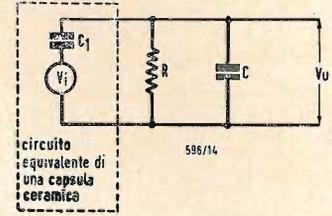
Fig. 13 - Circuito da usare con una capsula ceramica, quando deve alimentare l'entrata di un amplificatore di impedenza relativamente bassa.
